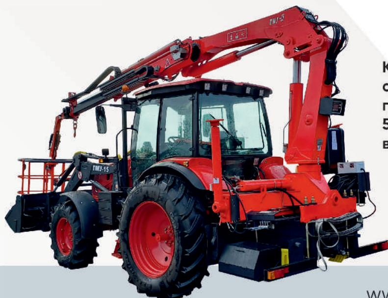
Комплектуется КМУ с максимальной грузоподъёмностью 5000 кг и с максимальным вылетом стрелы 8,05 м.
