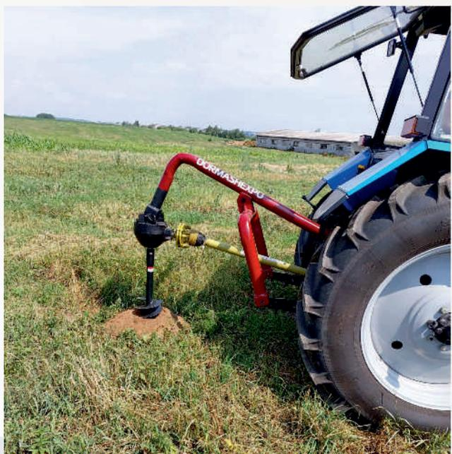
Назначение – для бурения грунтов I-IV категории под установку столбов, стоек ограждений, дорожных знаков, несущих опор, под посадку деревьев и кустарников. Привод бура осуществляется от ВОМ трактора через карданную передачу, снабженную предохранительной муфтой. Процесс заглубления и подъема рабочего органа осуществляется гидроцилиндром задней навески трактора. Управление навесным ямокопателем осуществляется из кабины базового трактора.
