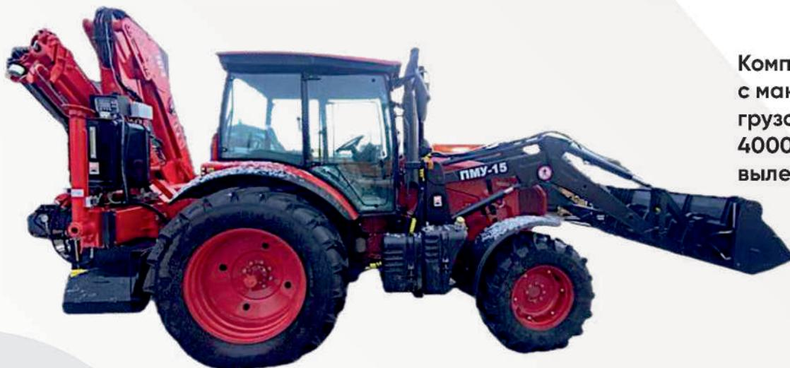
**Комплектуется КМУ с максимальной грузоподъёмностью 4000 кг и с максимальным вылетом стрелы 9,4 м.**
