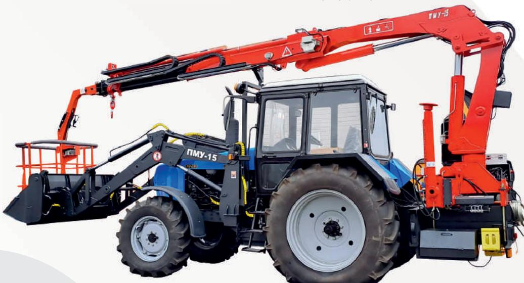
Комплектуется КМУ с максимальной грузоподъёмностью 3200 кг и с максимальным вылетом стрелы 9,4 м.
