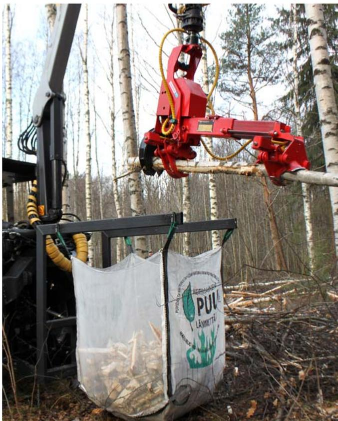
На голвку S23 нож может устанавливаться с клином для колки дров 25-50 см сразу после валки. Клин легко устанавливается и снимается посредством 3 болтов. На 3-точечную навеску трактора можно утановить наш кронштейн для навески биг-бэгов. Колка дров может производиться прямо в биг-бэг сразу после валки.
