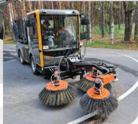
**Снегоуборочное технологическое оборудование** предназначено для уборки проезжей части, тротуаров и пешеходных дорожек от свежевыпавшего снега и наледи. Представляет собой две крупных подсистемы: пескосолеразбрасыватель и снегоуборочный прямой поворотный отвал (или снегоуборочная поворотная щетка роторного типа), смонтированных на базовом шасси.
